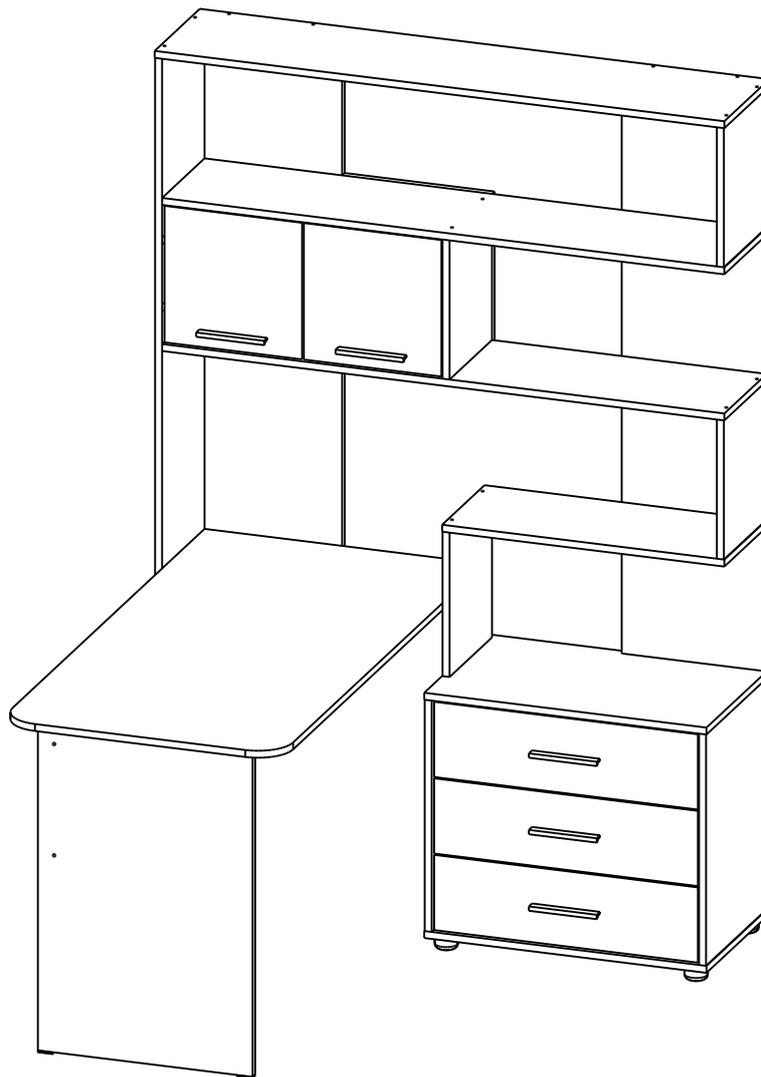
Максимальная нагрузка на роликовые направляющие до 8 кг. (нагрузка должна быть распределена по всей площади ящика).
